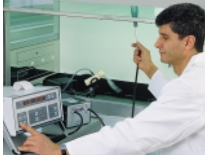
Einzelüberprüfung der Filterdichtigkeit in unserem Qualitätslabor
